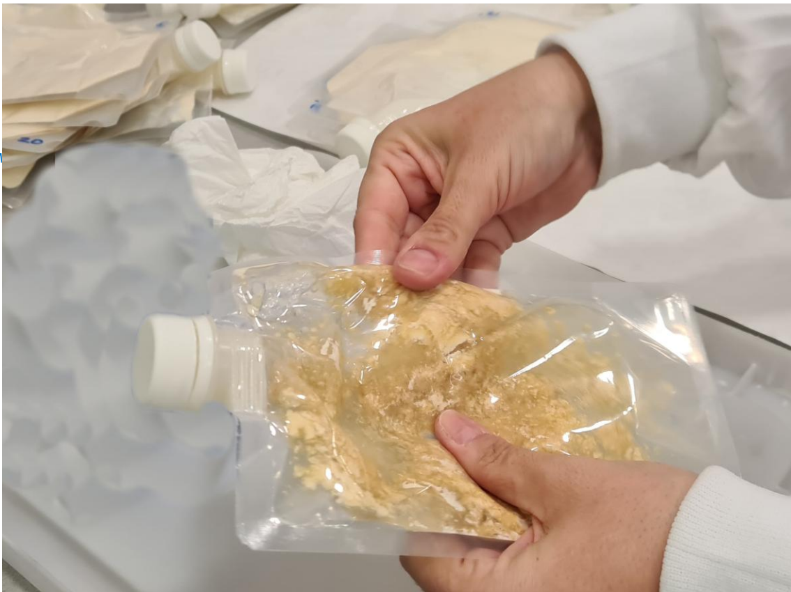
Modo de empleo QPA, Paso 5: Amasar con las dos manos para mezclar la muestra de agua con el medio en polvo, Puede doblarse la bolsa con fuerza para acelerar la homogeneización. Los grumos desaparecerán durante la incubación
