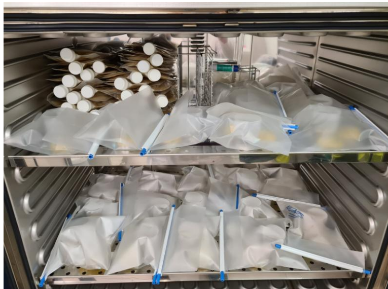
Incubación simultánea a 44°C de las placas de SPS en bolsas de anaerobiosis y de las bolsas QPA de TSC, todas juntas
