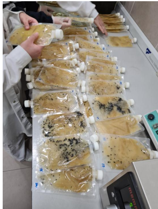
Modo de empleo QPA, Paso 8: Leer los resultados, contando las colonias negras. Si se hace al trasluz, se ven mejor las colonias del fondo del medio, lo que ahorra dar la vuelta a la bolsa y contar colonias dos veces. Si se desea identificar, abrir el tapón y pescar colonias con un asa de siembra
