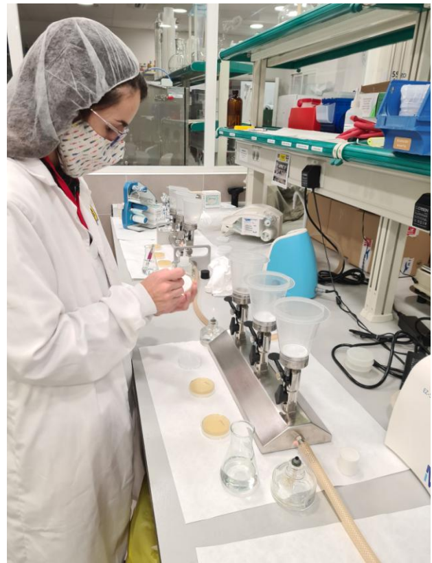
Filtración de dos réplicas por rampa, dos muestras cada vez
