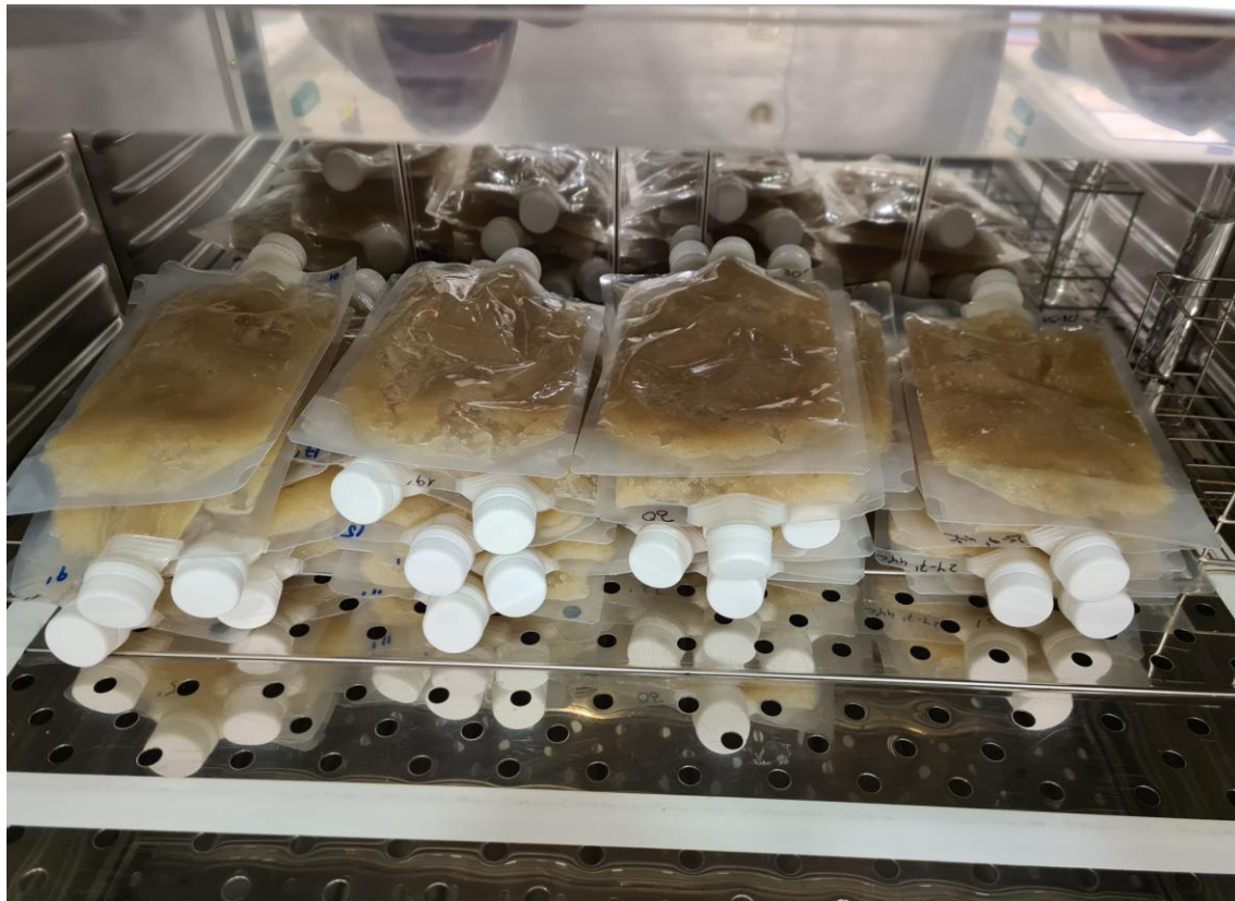
Modo de empleo QPA, Paso 7: Apilar las bolsas en la estufa, alternando el lado del tapón y buscando la estabilidad de la pila. Incubar 24 horas a 44°C
