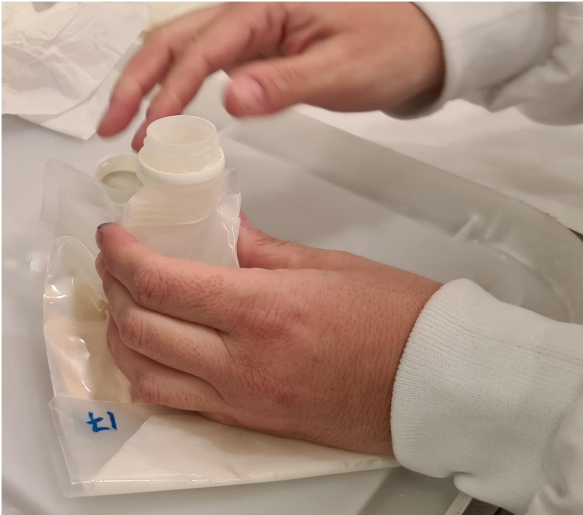
Modo de empleo QPA, Paso 2: Abrir el tapón con el fondo de la bolsa doblado y el medio en polvo encima del doblez
