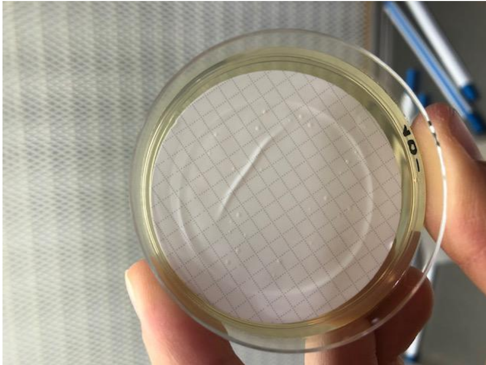
Frustrantes resultados del método oficial en 48 horas: ni una sola colonia negra en todo el experimento. Además, las colonias blancas pertenecen a interferentes
