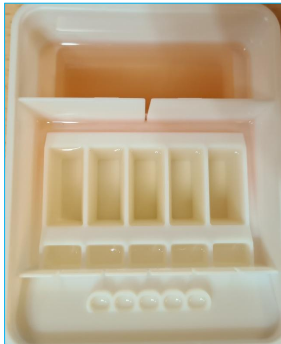
Prueba de que el método P/A es más sensible que el NMP: Una misma muestra de 100 mL, en los 55,5 ml del NMP (5 pocillos de 10 ml, 5 de 1 ml y 5 de 0,1 ml) da todos negativos, mientras los restantes 44,5 ml de la cubeta grande (P/A) da positivo para Pseudomonas aeruginosa con Pseudocult de MICROKIT: ¡Recuento 0 pero presencia! Esta foto es la bofetada que merece la actual normativa, por obligar a perder tiempo contando, para buscar legislativamente 0 ufc/100ml.
