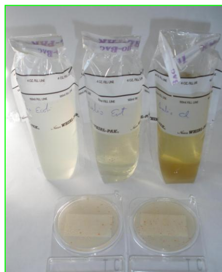
AGUA POTABLE: Los 3 P/A negativos y recuento bajo
