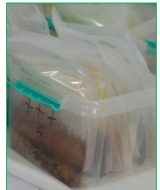
Bolsas Stomacher con 25 g de alimento, 225 ml de BPNW y 18 ml LEB Broth [x5] antes de incubar
