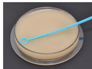
**7.-DIA 3:** Incubar las 8 Plaquis® en posición invertida, durante 48 horas a 35 °C. No apilar más de 10 Plaquis® y dejar espacio entre las pilas, y entre éstas y las paredes de la estufa. Sólo la de **Rapid YM Agar** y la de **MugPlus Agar** podrán leerse en las primeras 18-24h, de modo que para mayor comodidad, pueden leerse todas (las 8 plaquis®) a las 48 h.
