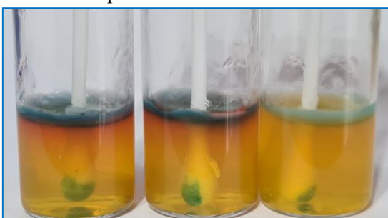
Foto izda: 12 h incubados, superficie azul antes del viraje del medio a fucsia. El tubo derecho, por tener el tapón apretado, obtiene falso negativo
